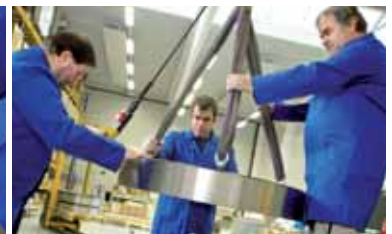
▼ Nagyméretű csapágyak összeszerelése
