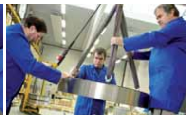
▼ Montáž velkorozměrových ložisek
