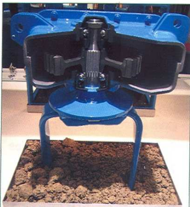
Modelo seccionado del rotor de una grada rotativa de Lemken con unidad de rodamiento de NKE.
