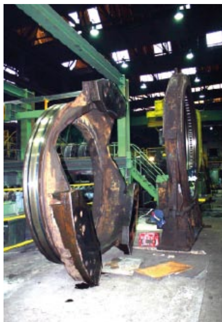
Der Stützring mit Lagerinnenring (links), das Lagergehäuse mit Rollen, Käfig und Außenring (rechts)
