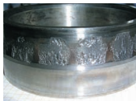
A destra. Danno tipico di un cuscinetto causato da un uso improprio. Un addestramento idoneo aiuta a evitare tali errori prolungando la durata di vita.
