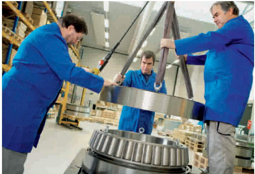
Ein größeres gepaartes Kegelrollenlager wird von NKE-Mitarbeitern in Steyr montiert.
